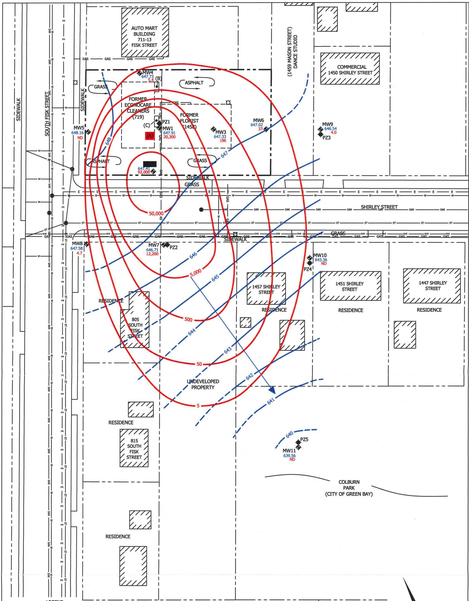
**MW11** GROUNDWATER MONITORING WELL LOCATION & GROUNDWATER ELEVATION (FT) & PCE CONCENTRATION IN GROUNDWATER (MICROGRAMS PER LITER)
